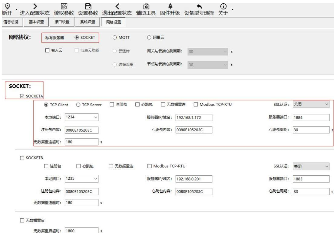
图 8 网关网络参数设置
